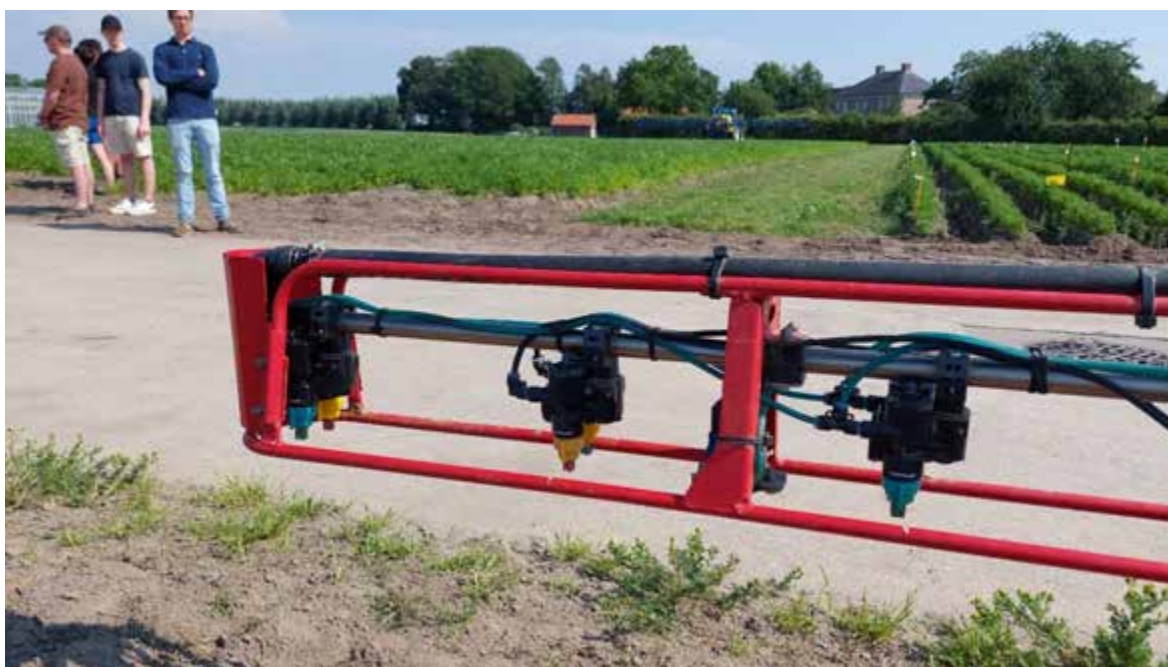
Figuur 7: Doppen op 30 cm met verschillende afgiftes op de Kverneland Ixter gedragen spuitmachine
