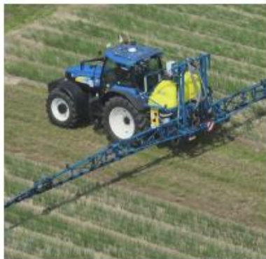
Croptic demonstreerde via een Delvano gedragen spuitmachine (in dit geval met pulserende doppen) hoe plaatsspecifieke onkruidbestrijding kan gebeuren.
